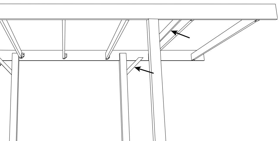
**NL:** Monteer eveneens de verstekverstevingen zoals op de figuur. Gebruik per versteviging 2 schroeven van 70mm, nadat U voorboorde.
