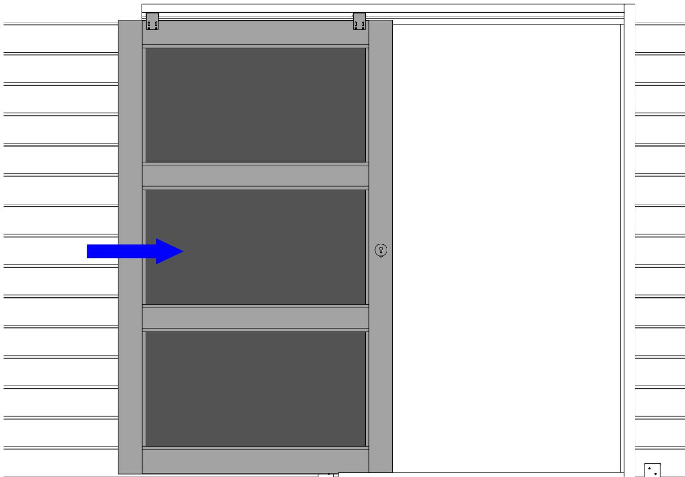
NL: Hang de deur in de rail, montere slot, cilinder en het handvatje aan de buitenkant.
