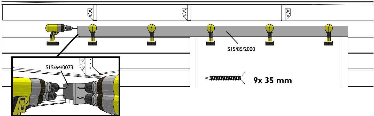
46. **NL:** Sierlat buitenkant boven de deur - **FR:** Latte de finition au-dessus de la porte côté extérieur.
