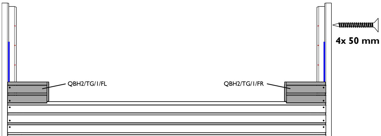
**NL:** Breng lijm aan in de groef van het raam en plaats het raam in de opening tussen de 2 korte stukken.
