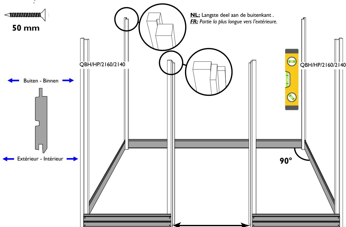
**NL:** Enkele deur = 900mm / dubbele deur = 1504mm.
