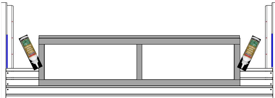
**NL:** Bevestig aan de binnenkant het raam door de groef aan de tand van de kleine stukken. Zorg er voor dat de onderzijde van het raam mooi overloopt in de lijn van de kleine stukken. Vergeet hier zeker niet voor te boren!
