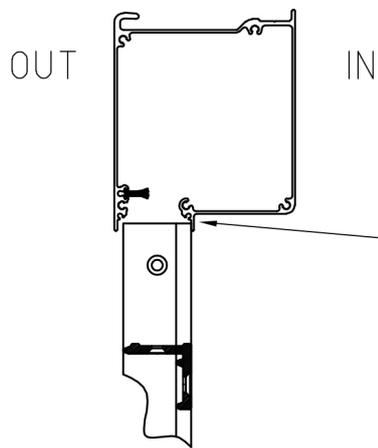
Fixer le cadre du rail D au poteau de gauche, le rail doit être aligné verticalement à la partie intérieure du store (pièce A)
