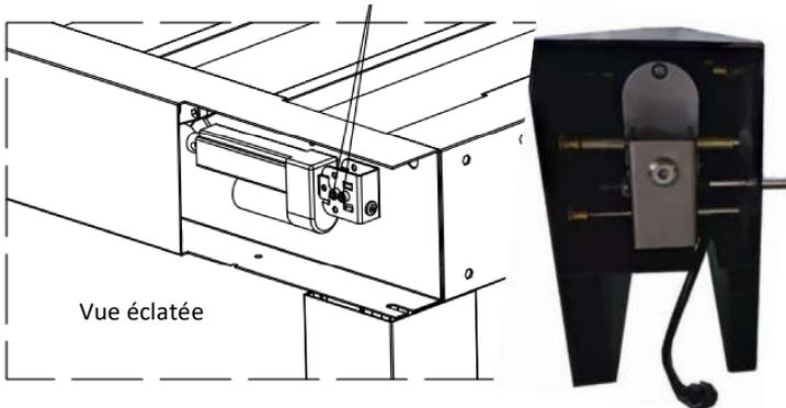
En accédant par le coté de la poutre moteur, desserrez les deux vis de verrouillage.
