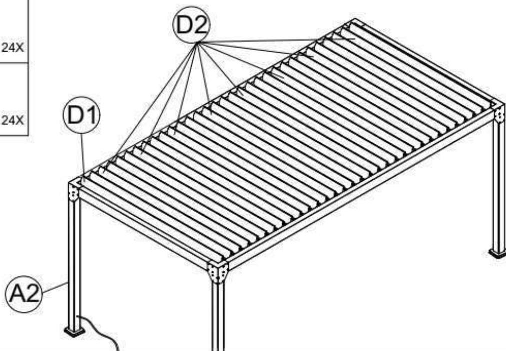
Connecter l'alimentation LED aux lames équipées des bandeaux LED.
