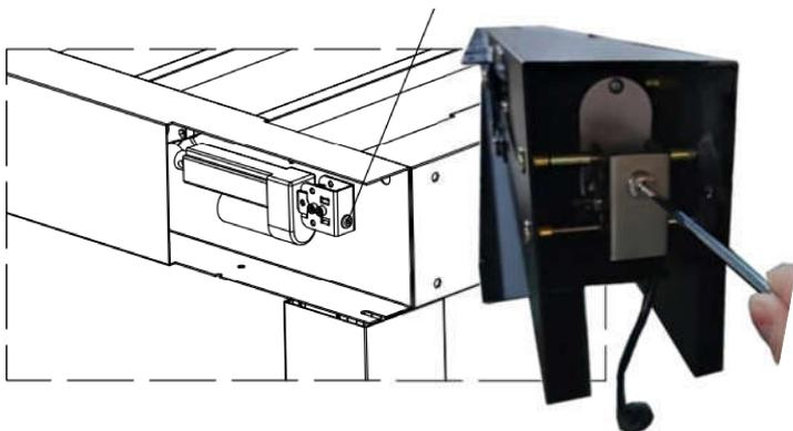
Réduisez l'écart des lames en tournant la vis dans le sens des aiguilles d'une montre.
