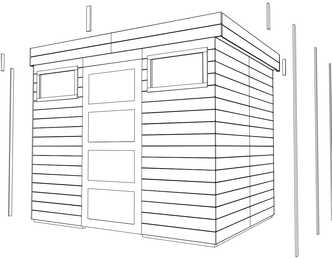
**NL:** Werk het tuinhuisje af. Monteer de verticale sierlatten panelen met telkens 4 vijzen van 35 mm en de verticale sierlatten dakhoeken met telkens 2 vijzen van 35mm.
