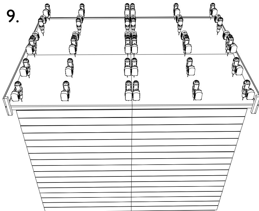
**NL:** Monteer de dakplaten op de dakbalken met 9 vijzen van 50 mm per dakplaat.
