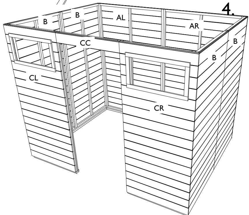
**NL:** werk de wanden verder af door de panelen telkens met 3 vijzen van 50 mm aan elkaar te vijsen en met 2 vijzen van 50mm aan de vloer(-balken). Voor het paneel CC gebruikt u slechts 4 vijzen van 50 mm. Vergeet ook hier niet rekening te houden met de zwelnaad van 5 mm rondom. Hou de panelen tegen zolang u de volgende hoek niet vastgemaakt hebt aan de vloer(balken). Ga na of alles mooi pas gemonteerd is.
