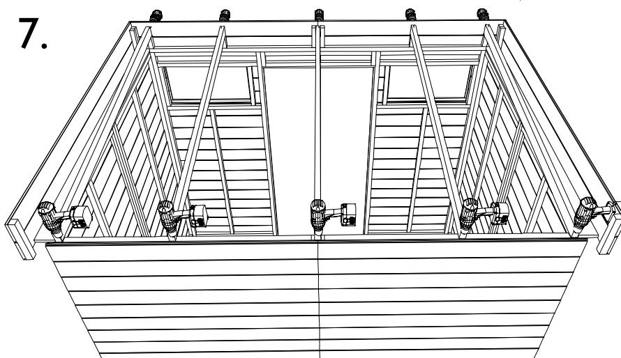
**NL:** Plaats de dakbalken vooraan op de voorziene steuntjes. Vijs de dakbalken vooraan vast door de frontale sierlijst met telkens 2 vijzen van 70 mm., mooi in het midden van de dakbalk (voorboren!). Maak achteraan gebruik van de meegeleverde L-ijzertjes en schroeven van 25mm om de dakbalken vast te maken op de kader van de achterwand.
