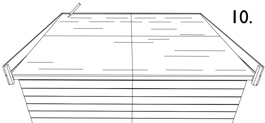
**NL:** Breng op regelmatige afstanden een streep universele lijmkit (niet meegeleverd) aan op de dakplaten.
